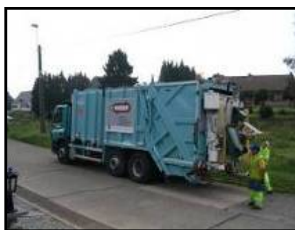
DifTarwagens werden speciaal uitgerust om het opgehaalde container ter plaatse te wegen
